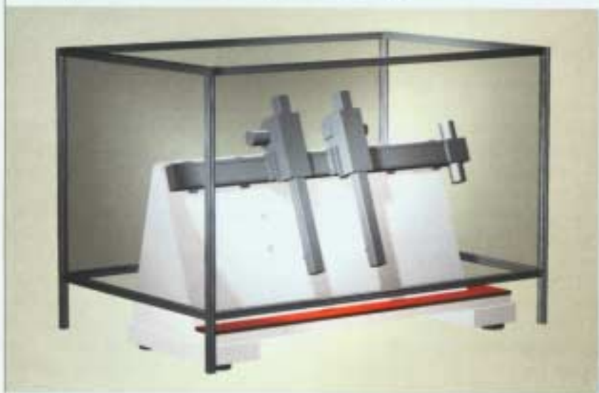
Die Doppelachsen-Lineareinheit Robot 2C. Bilder: El.More
